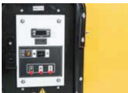
Izgorevanje je digitalno nadzirano. Kontrolna plošča omogoča nastavitve digitalnih parametrov.
