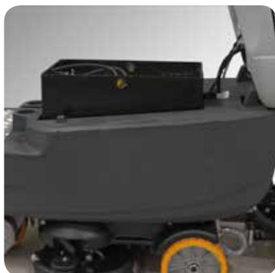
50 kg. di pressione continua del piatto spazzole con sistema autolivellante per rimuovere efficacemente qualsiasi tipo di sporco da tutti i pavimenti. Robuste ruote in poliuretano antiolio. Vano batterie per batterie da 500 Ah C5 che consentono lunghi tempi di lavoro in continuo..
